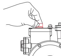
2. 當泵浦入口低於水源時，取下注水塞，讓水自行流進泵室注水，重複多次至不含空氣後，再將注水塞旋緊即可。
